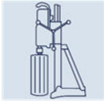
Carotteuse électrique à eau avec mèche diamantée (HILTI D150 ou DD250 recommandée) et Support de carotteuse (« tour »)
